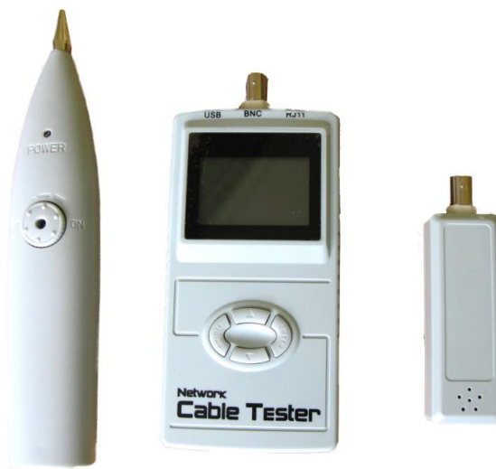
Zleva-doprava: sonda, měřící přístroj, loopback
