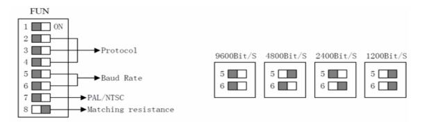
Baud Rate Options: 1200BIT/S 、2400BIT/S 、4800BIT/s、9600BIT/s
