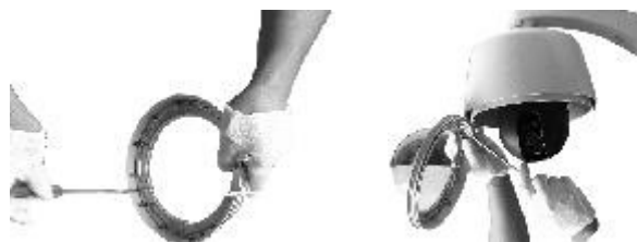
Ukotvěte průhledový kryt
