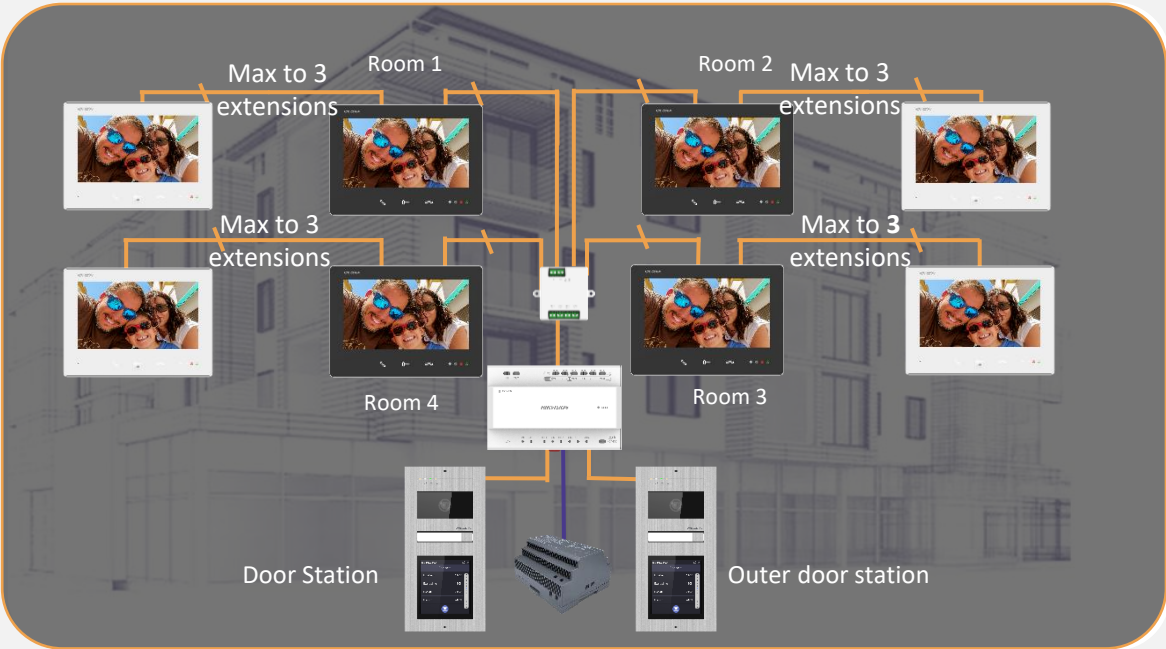
Hvězdicové připojení přes DS-KAD7061EY maximálně 4 hlavní vnitřní stanice ze 4 portů KAD7061EY
