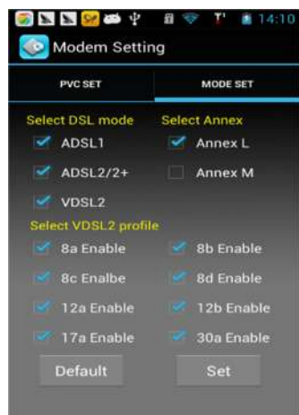
VDSL2 Modem parameter setting interface 2
